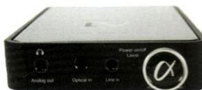
音声入はUSB、ステレオミニ(3.5mm)、光デジタルを1系統搭載する。入力はAndroid line in/Optical/USB DACから選択する
